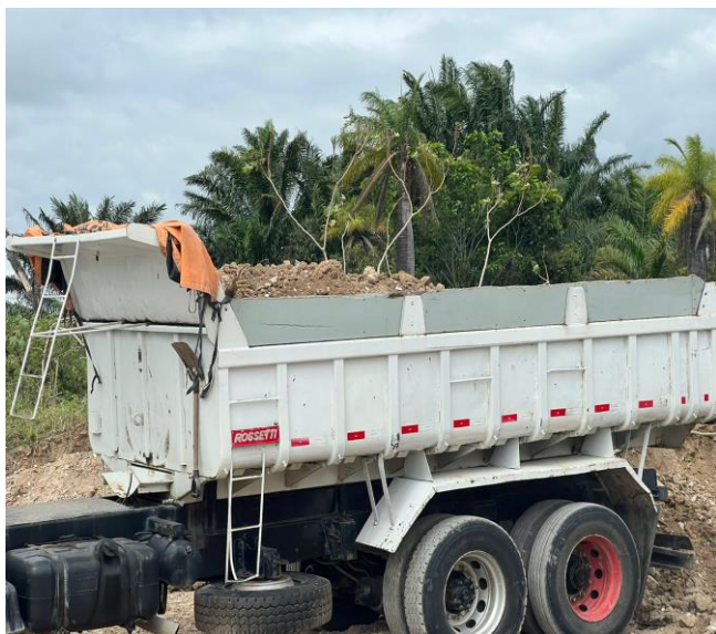
Transporte Com Caminhão Basculante De 6 M 3 , Em Via Urbana Pavimentada, Dmt Até 30 Km (Unidade: M3Xkm). Af_07/2020
